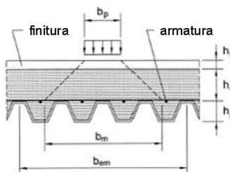
Fig. 4.3.12 - Diffusione del carico concentrato
