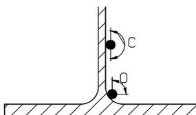
Fig. 4.3.10- Perimetro efficace delle barre di armatura.
